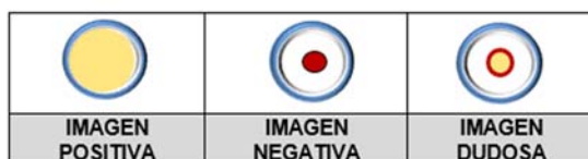
FIGURA 1. ESQUEMA DE LA PRUEBA CUALITATIVA HEMAGLUTINACIÓN INDIRECTA (HAI) CHAGATEST WIENER LAB.
